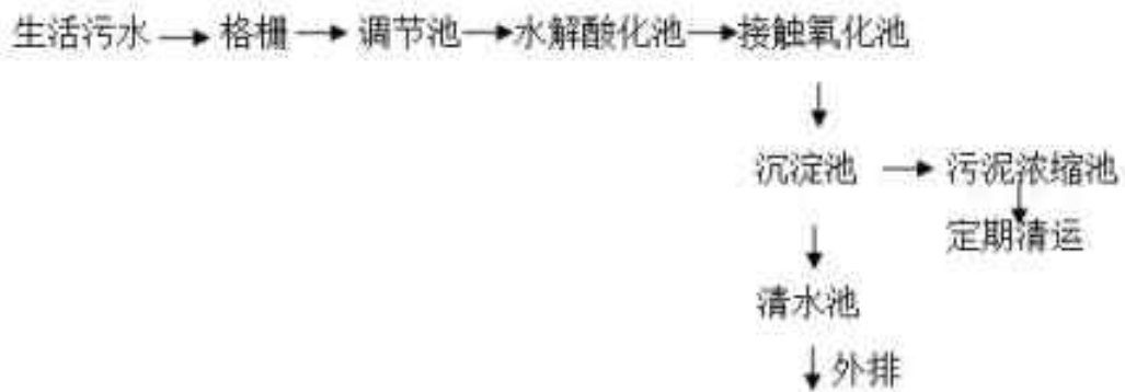
图 2-2 污水处理工艺流程图
