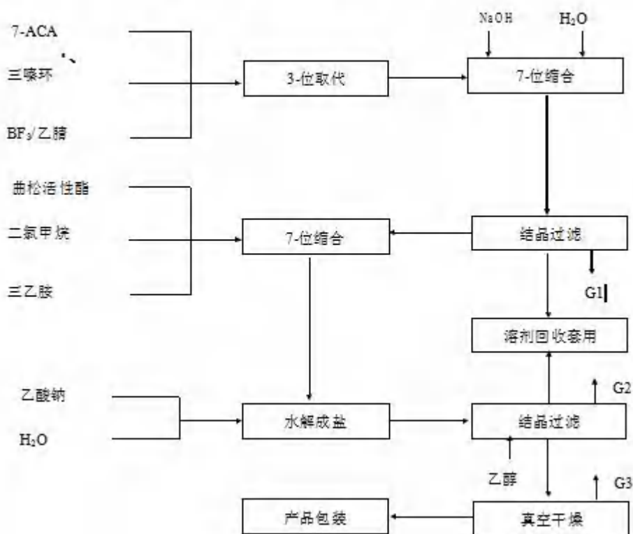
图 2.4.5 头孢曲松钠工艺流程图
